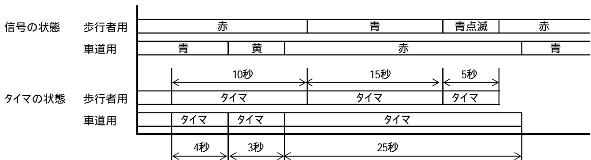
付図6．ボタン押下からの状態遷移のタイミングチャート
